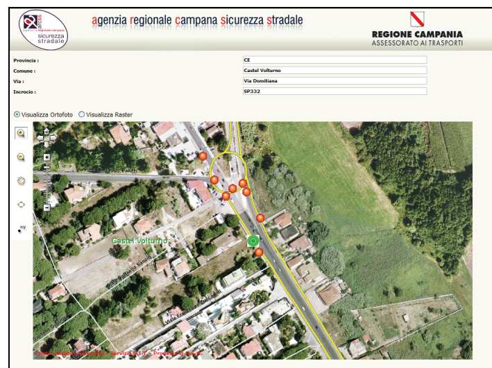
Figura 1 – Una videata del sistema informativo del CRISS (localizzazione dell'incidente)
